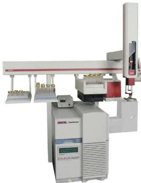
Figure 1. Gerstel ChemSensor.
