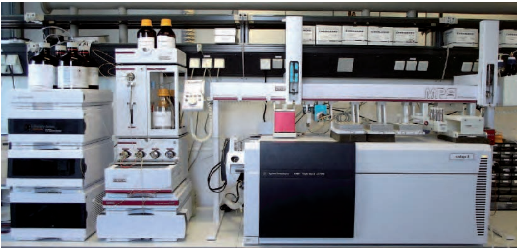
Verwendetes SPEXOS-HPLC-Triple-Quad-System zur Bestimmung von Phenylharnstoff- und Triazin-Herbiziden.
