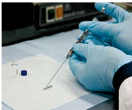
Aufgabe einer POP-Standardlösung mit einer Mikroliterspritze auf den Twister
