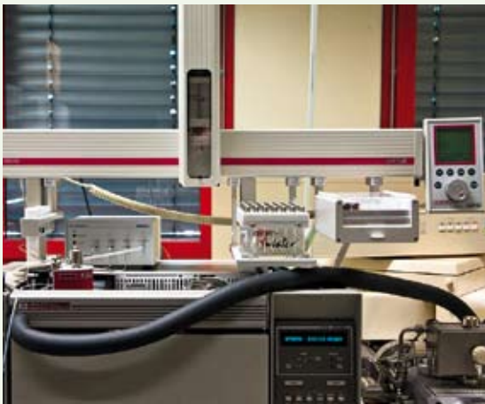
Das vom GSF Forschungszentrum verwendete GC/MS-System zum POP-Nachweis. Die Twister-Analytik erfolgte mittels GERSTEL-MPS und GERSTEL-TDU (rechts oben) vollständig automatisiert.
