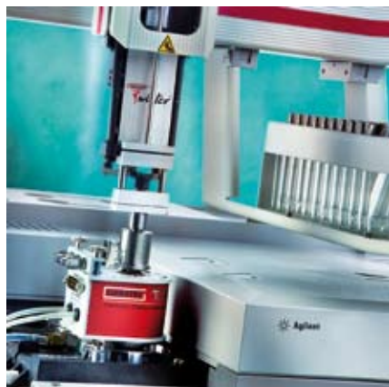
Von TNO verwendetes SBSE-MPS-GC/IRMS-System.
