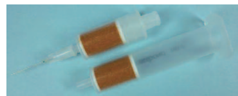
Figura 2: Acima: Cartucho de extração em fase sólida configurado para SPE GERSTEL automatizada. Abaixo: Cartucho de extração em fase sólida.
