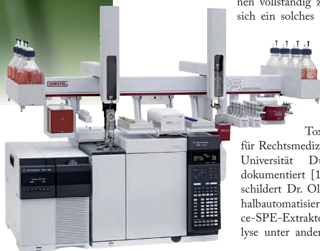
GC/MS-System zur automatisierten Probenvorbereitung (SPE, Eindampfen, Derivatisieren), verwendet für die Bestimmung von Opioiden und Cocain und deren Metaboliten, ebenso für den Nachweis von THC und dessen Abbauprodukte im Blutserum [3].
