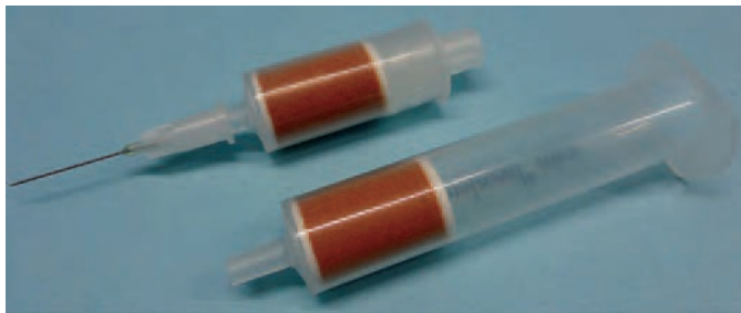
Standardkartusche für die herkömmliche Festphasenextraktion (u.) im Vergleich mit der modifizierten SPE-Kartusche für die automatisierte Vorgehensweise auf dem MPS-Autosampler.
