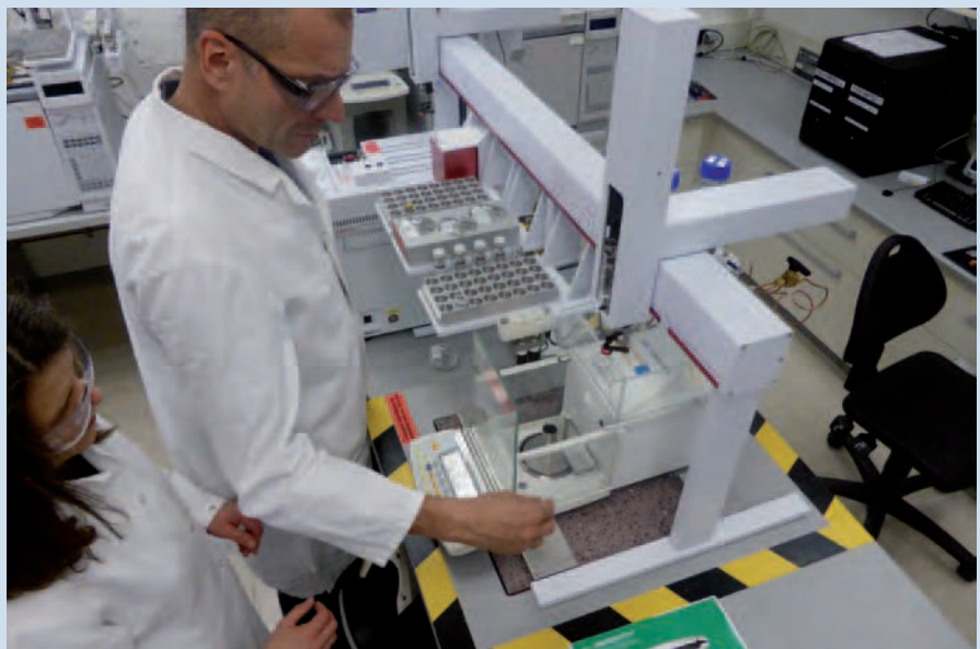
Im Zuge der Neustrukturierung des Labors legte man bei Schülke & Mayr großen Wert auf eine automatisierte Probenvorbereitung. Im Fokus stand die Anschaffung eines Autosamplers, der über eine integrierte Wägeoption, sprich: eine Waage verfügt, um u. a. automatisiert Dosierschritte mittels Differenzwägung überprüfen und protokollieren zu können. Fündig wurde das Unternehmen bei GERSTEL und dem MultiPurposeSampler (MPS).
