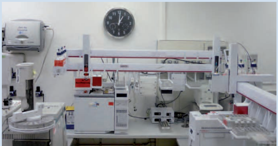
Sämtliche GERSTEL-MPS bei Schülke & Mayr verfügen nicht nur über eine Wägeoption, sondern ebenso über zwei Türme (Arme), um unterschiedliche Volumina dosieren zu können, ohne die Spritze tauschen zu müssen. Die „Brücke“, ein MPS im XL-Format, beschickt nicht nur ein GC-System, sondern zudem auch noch einen herkömmlichen Autosampler zur Rechten.
